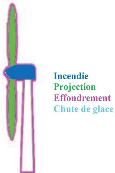
Figure 33 : Potentiels de dangers d'une éolienne
